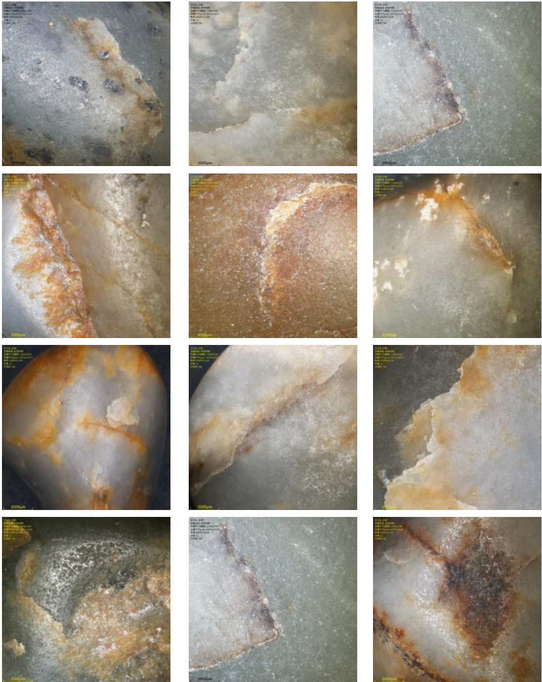
图E.1 和田玉（子料）表面微形貌裂隙特征（超景深显微镜）
